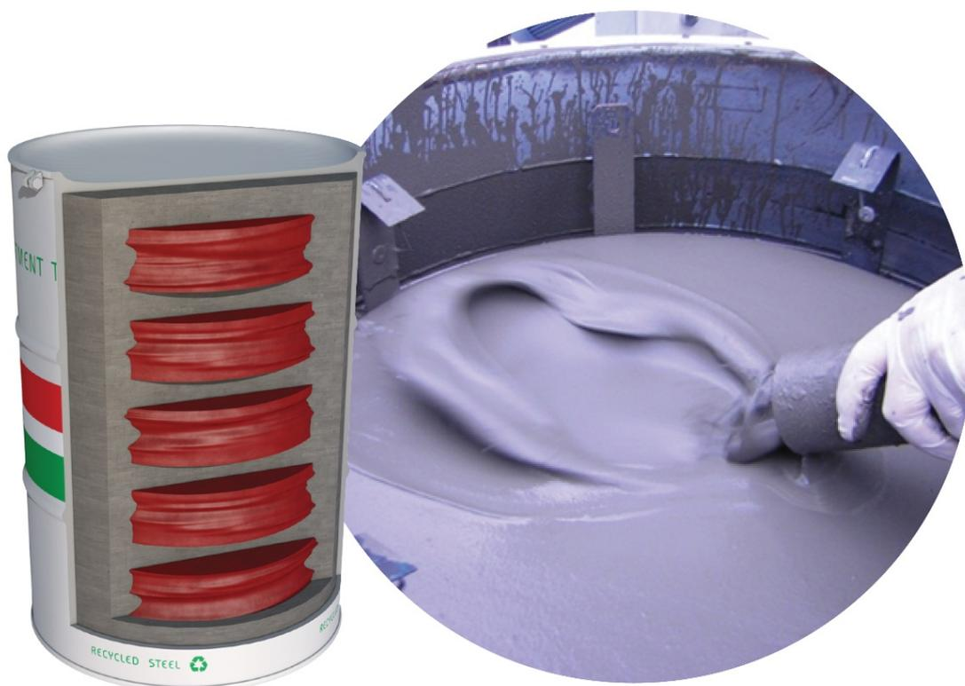
Figura 1. Esempi di rifiuti condizionati in contenitori cilindrici.
