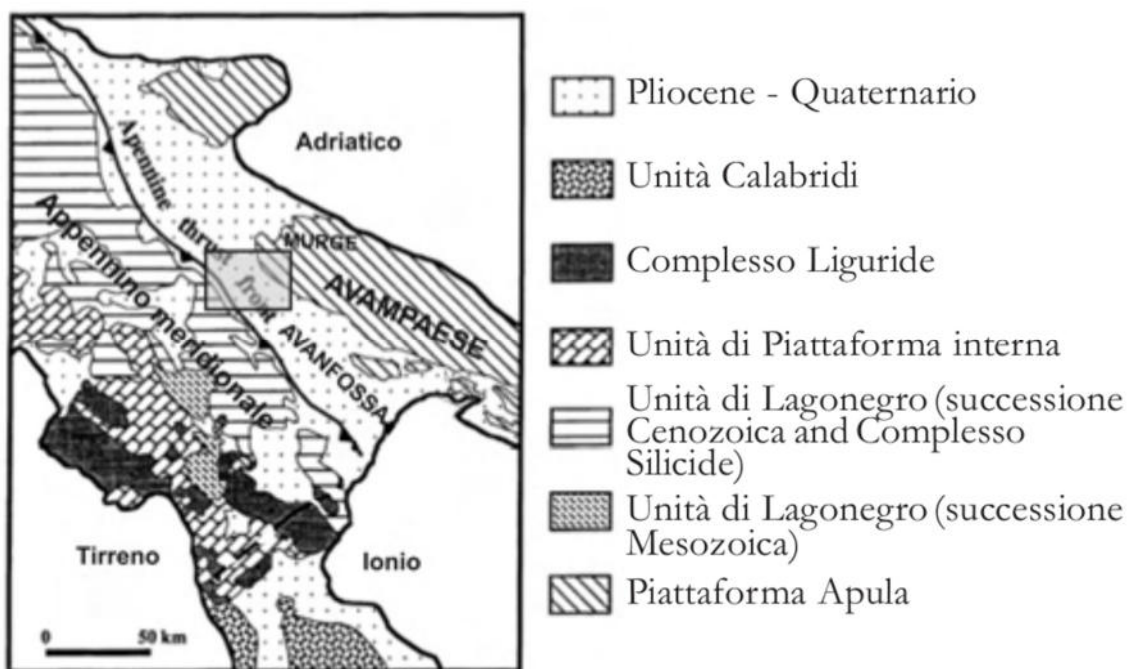
Figura 29 - Carta geologica semplificata dell'Appennino meridionale in corrispondenza della Fossa Bradanica (da Lazzari M., 2008).
