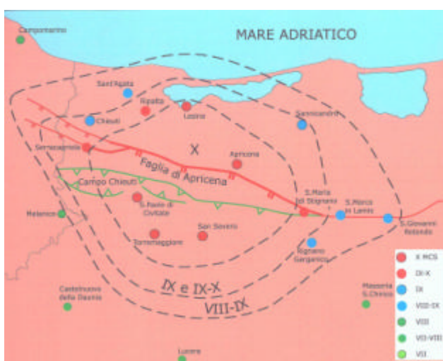
Fig. 6 - Campo macrosismico del terremoto del 30/07/1627) e traccia del segmento della faglia di Apricena i. In verde è indicata la struttura del campo Chieuti.
