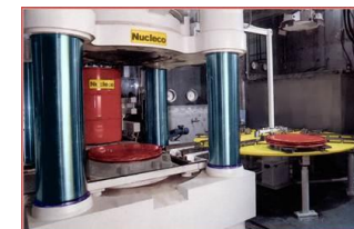
Infustamento in overpack per la cementazione
