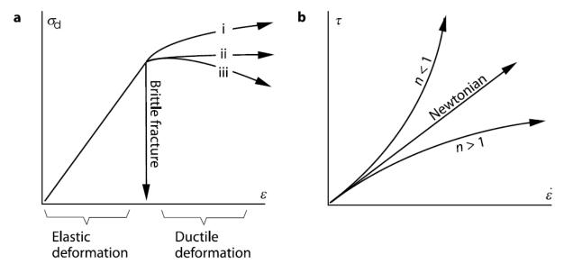
**Figura 1.2** a) Deformazione fragile e b) deformazione duttile. Nel regime fragile la forza dipende direttamente dalla grandezza degli sforzi principali, nel regime duttile, tutte le sollecitazioni differenziali determinano una deformazione permanente e la resistenza dipende dalla velocità di deformazione
