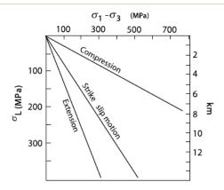
**Figura 1.3** Criterio di rottura fragile lineare descritto in base ai tre regimi tettonici, compressivo, trascorrente ed estensionale
