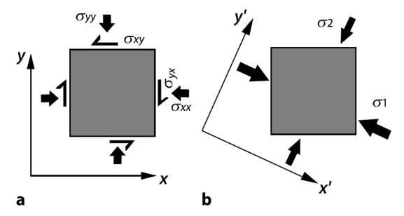
**Figura 1.1** a) Componenti principali del tensore di stress b) Sistema di x', y' and z' in cui tutte le componenti di taglio diventano zero
